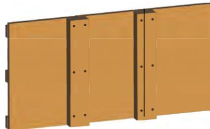
Modélisation de la pose de bardage à couvre joint.
